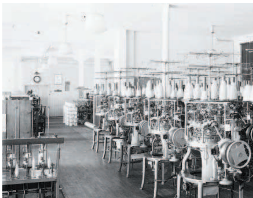
Links Kettenstühle und rechts Rundstrickmaschinen in der Wirke (Firma Wolff). Fotograf: Rudolf Dür, 1940er Jahre
